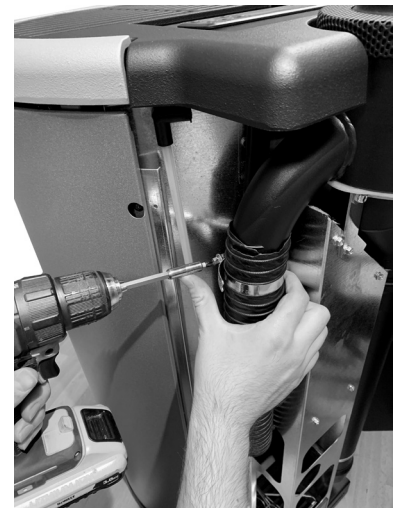
Fig. 53 - Flexibele buis naar buiten trekken
