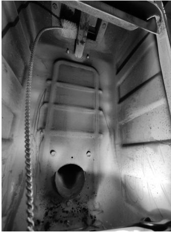
Fig. 72 - Reinig met pijpenwisser
