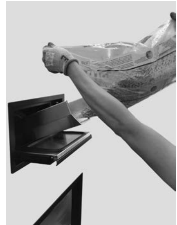
Fig. 38 - Laden van de pellets met schuiflader
