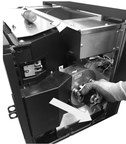
Fig. 97 - Verwijdering van de schroeven
