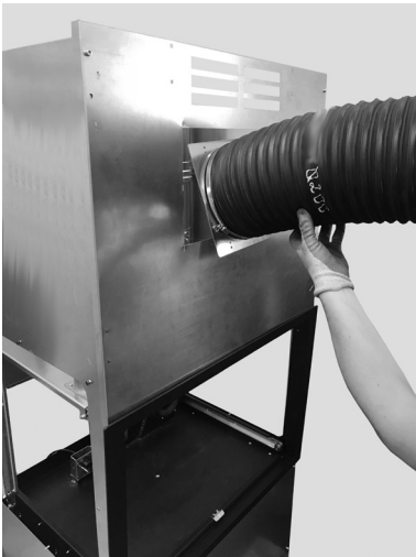
Fig. 65 - Plaatsing flexibele buis
