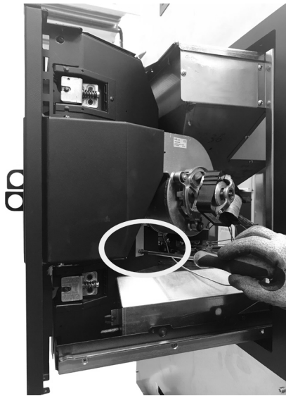
Fig. 96 - Verwijder de ventilator
