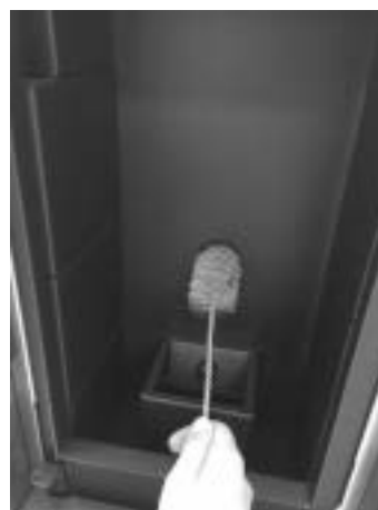
Fig. 36 - Nettoyage avec nettoie-pipes
