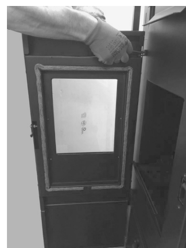
Fig. 40 - Draai de schroef los
