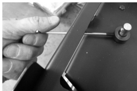
Fig. 91 - Draai de schroef los met een sleutel van 2,5 mm
