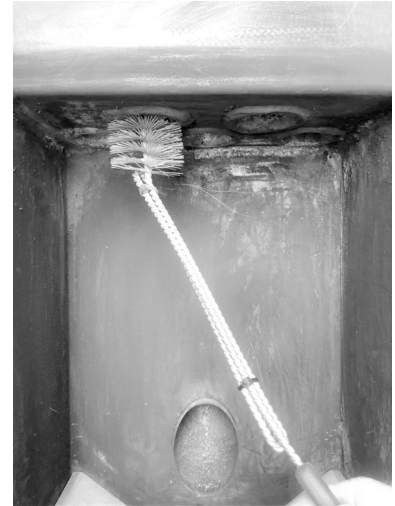
Fig. 83 - Reinig met pijpenwisser
