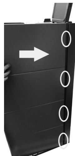
Fig. 48 - Maak het zijpaneel los
