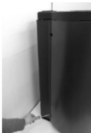
Fig. 66 - Svitare le viti laterali
