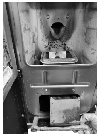
Fig. 70 - Rimuovere tappo ispezione
