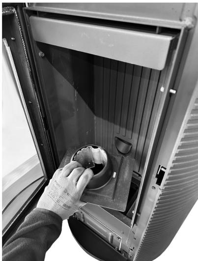
Fig. 36 - Rimozione braciere
