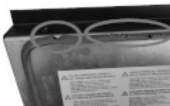
Fig. 25 - Guarnizione deteriorata
