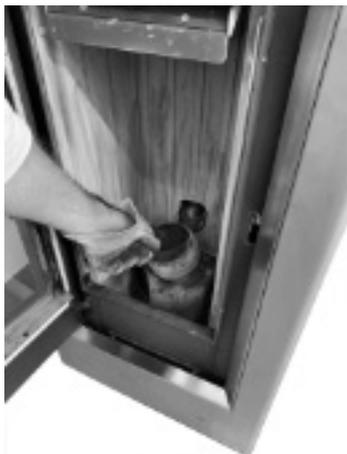
*Fig. 32 - Rimozione braciere*
