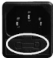
Fig. 69 - Hublot avec les fusibles à enlever
