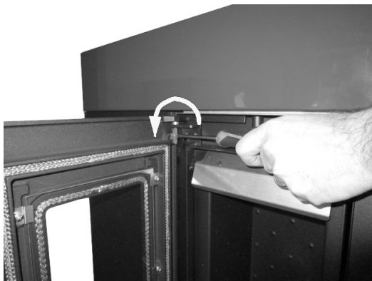
Fig. 17 - Extracción de los tornillos
