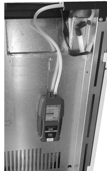
Fig. 39 - Conexión del presostato digital
